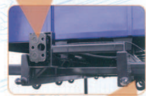
Etrier turnat din oțel pentru menținerea caroseriei pe șasiu.
