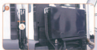
Rezervor hidrolic cu capacitatea medie de 110 litri. Concepția și montarea sa îi permit să rămână în partea din spate a cabinei.
